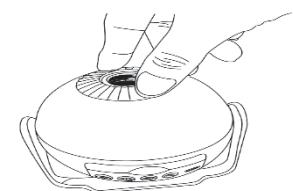
3. Регулируйте яркость, поворачивая верхнюю часть устройства.
