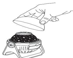
1. Поверните, чтобы снять крышку для боковой проекции.
